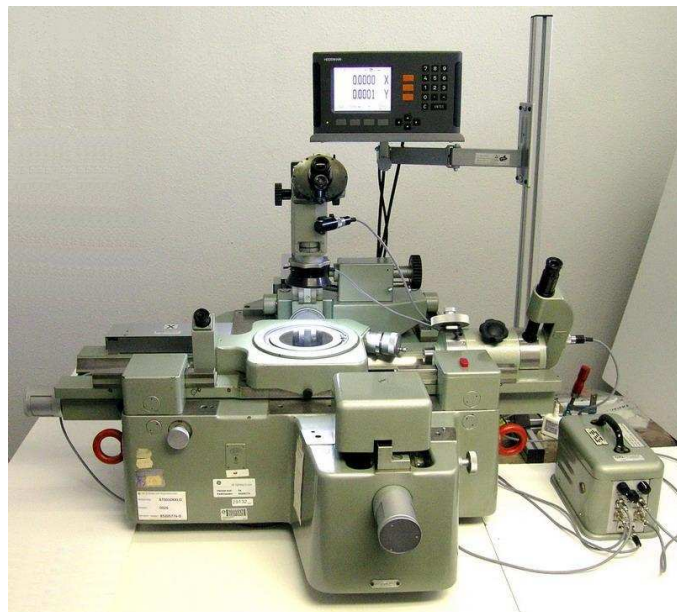
X-Y mérőmikroszkóp korszerűsítés után
